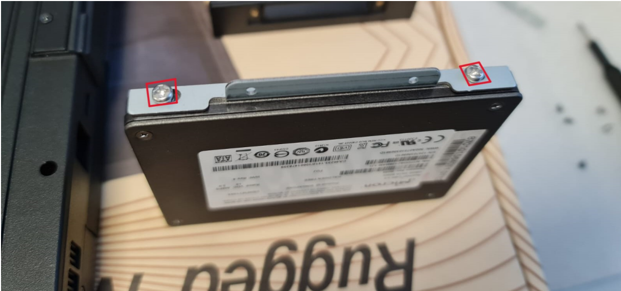
4. Montieren Sie Ihre Festplatte wie gezeigt auf die Montageschienen
