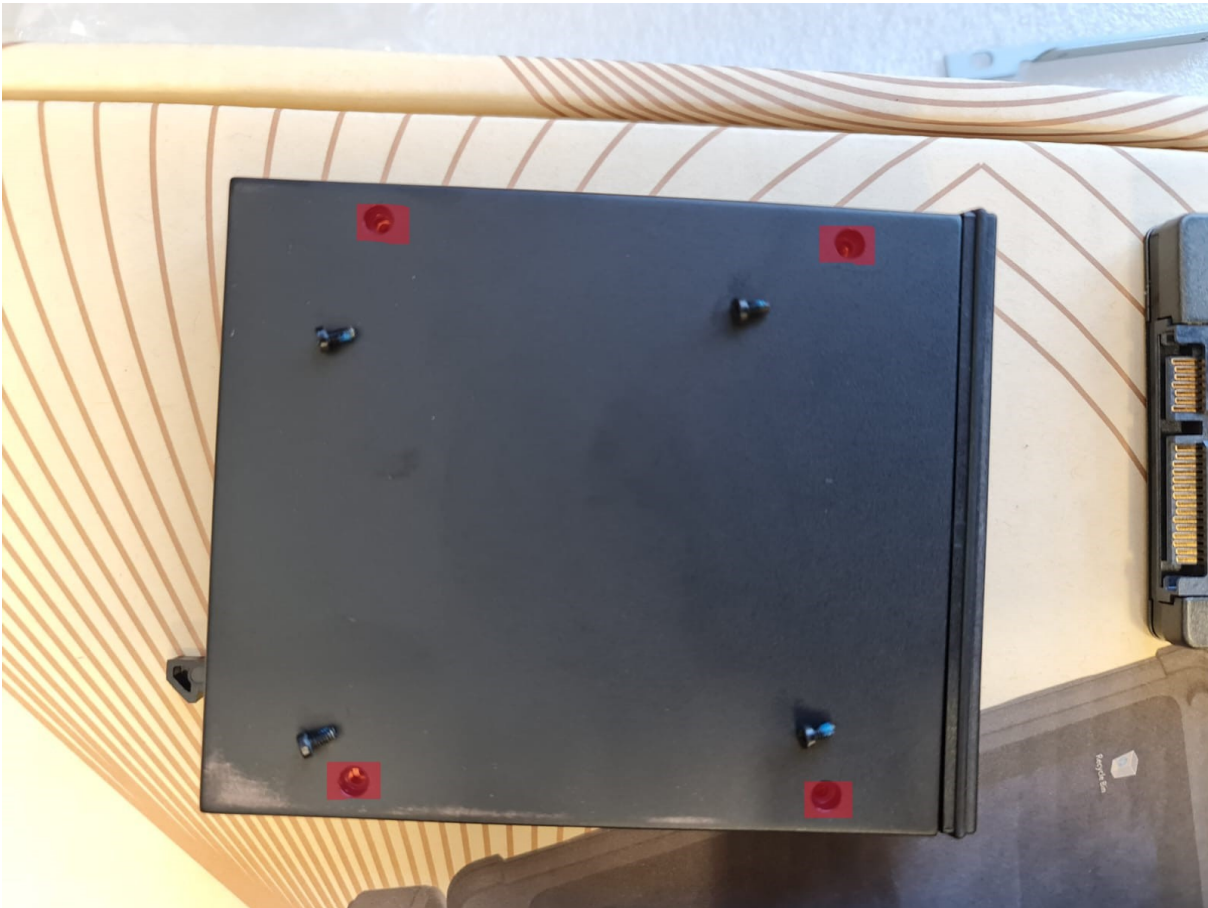
4. Montieren Sie Ihre Festplatte wie gezeigt auf die Montageschienen
